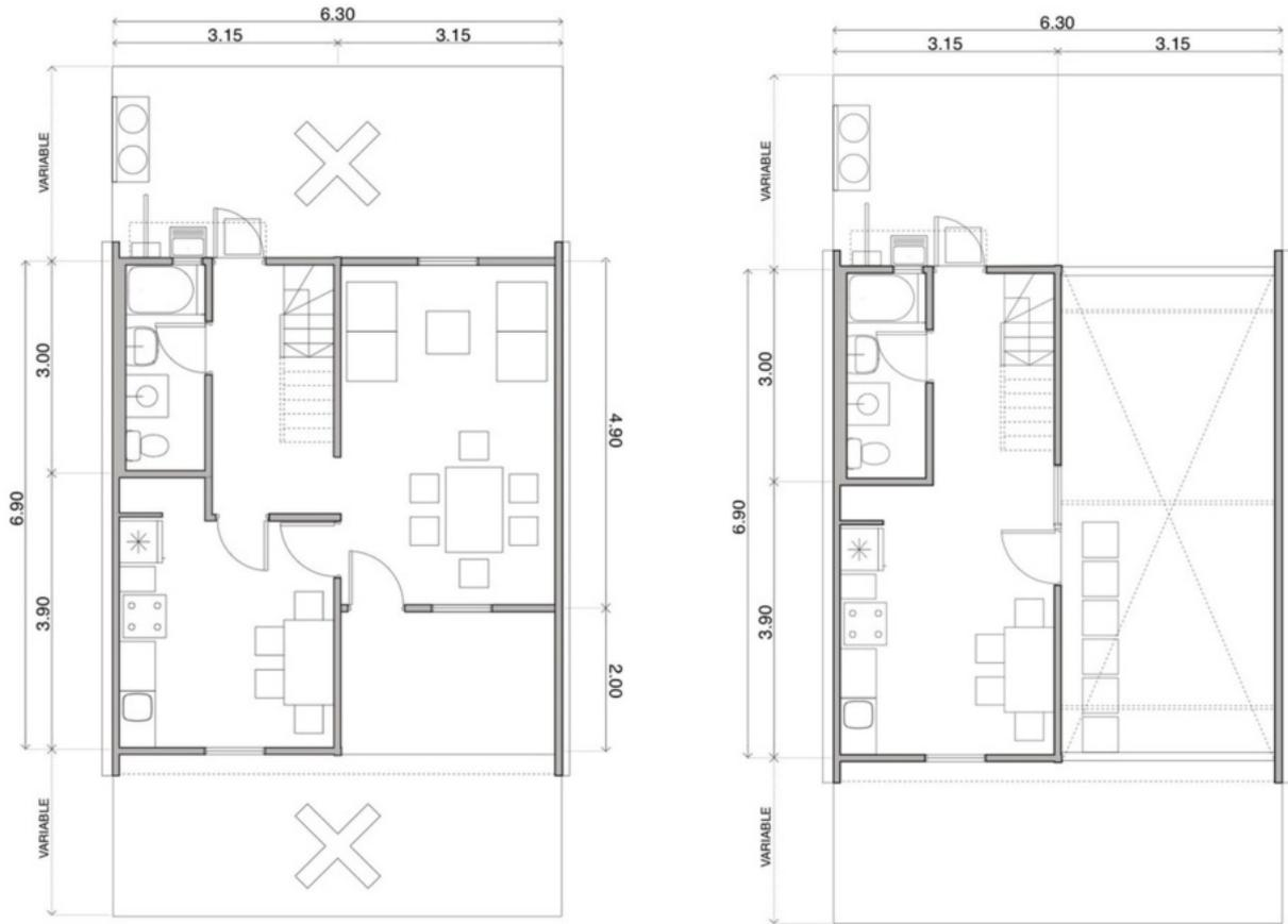
**Fig. 09:** Planta baixa térreo com proposta de ampliação. Fonte: ArchDaily, 2010.
