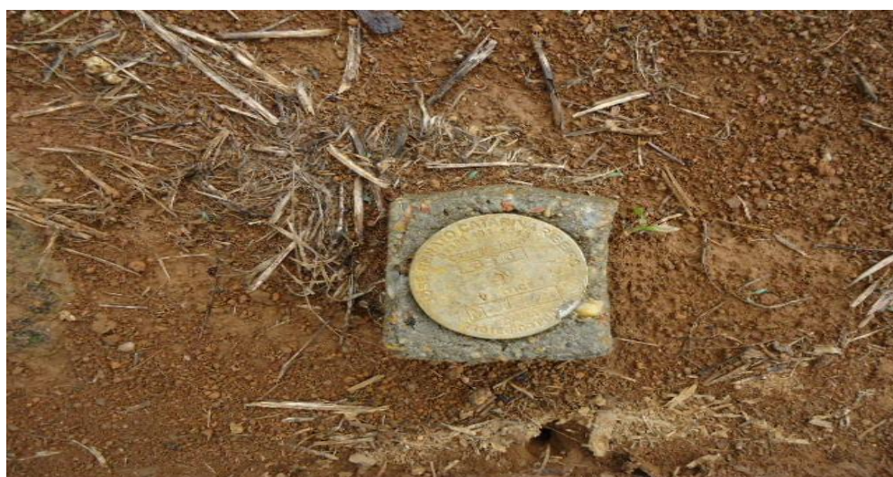
Figura 3. Marco instalado no vértice de uma propriedade
