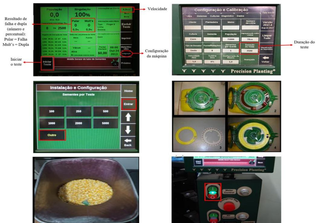
Figura 4. Equipamento de plantabilidade (MeterMax). Fonte: Autoria própria, 2022.
