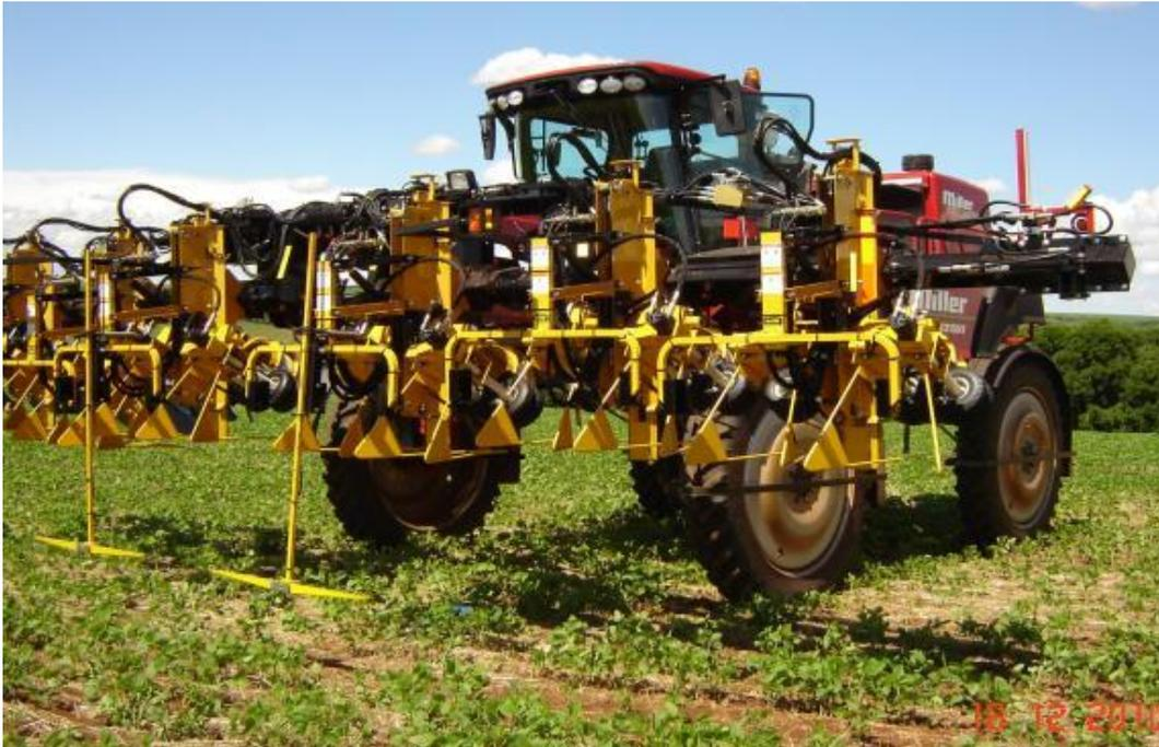
**Figura 14.** Despendoador mecânico modelo Miller. Fonte: Autoria própria, 2022.
