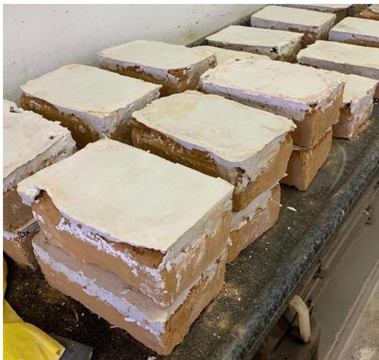
Figura 3.11: Tijolos de adobe capeados Fonte: do autor (2019)
