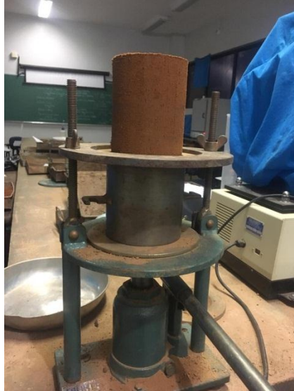
Figura 3.3: Corpo de prova moldado, no cilindro de compactação Fonte: do autor (2019)
