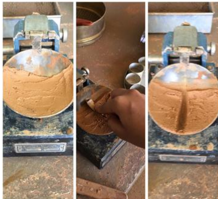
Figura 3.1: Etapas do ensaio de limite de liquidez Fonte: do autor (2019)
