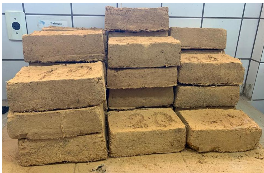
Figura 3.10: Tijolos de adobe secos Fonte: do autor (2019)
