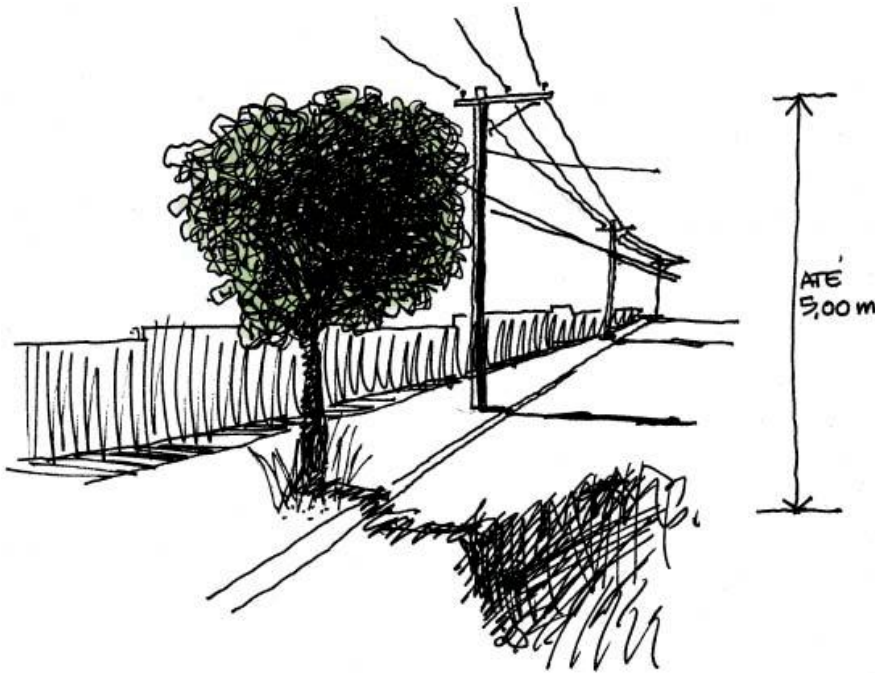
Figura 12: Ilustração 05 - Árvore de pequeno porte, tamanho recomendado para não ter conflito com a rede elétrica.
