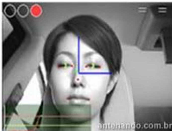
Figura 4: Leitor facial anti-bêbado (Veículo Nissan)
