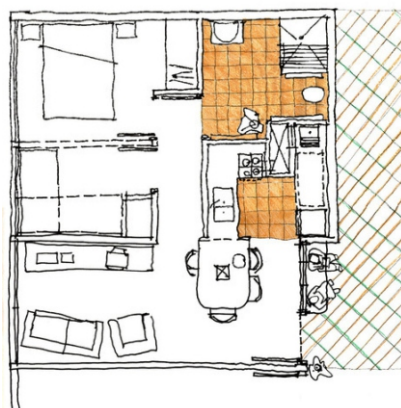
Figura 30: planta baixa apartamento e sugestão de colocação de paredes móveis (parede tracejada) Fonte: VIGLIECCA&ASSOCIADOS, 2016
