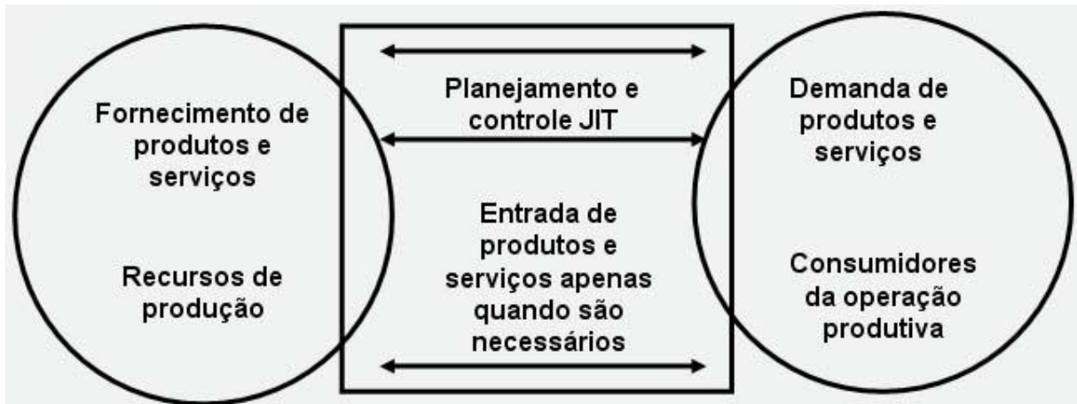
Figura 31 O planejamento e controle Just In Time visa atender à demanda instantaneamente, com qualidade perfeita e sem desperdícios. Slack, Chambers e Johnston (2002, p.481).
